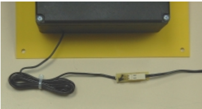
Thermofühlerleitung mit Zwischenstecker
