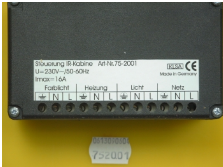
Die Ansicht auf die Anschlussklemmen.
